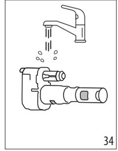
7. اشطف موصل دورق الحليب بعناية (E6) (الشكل 34)، انتبه واحرص جيّداً على عدم بقاء أي بقايا للحليب على قناة تجميع الهواء (عند التكبير) (الشكل 35) عند وجود بقايا أو رواسب؛ استخدم عود تخليل الأسنان لإزالة أي بقايا أو رواسب؛
