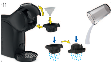
11 Rimuovere il contenitore. Svuotare il contenitore e pulirlo. Estrarre il supporto per capsule. Rimuovere l'utensile per il risciacquo. Conservarlo in un luogo sicuro per pulirlo e decalcificarlo in un secondo momento. Pulire entrambi i lati del supporto per capsule con acqua potabile fresca. Reinserrire il supporto per capsule.
