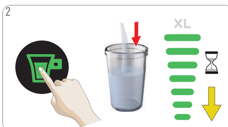
2 Um das Abkühlen zu beschleunigen, Stufe 7 auf der Leuchtbalkenanzeige wählen. Start/Stop-Symbol antippen. Die Maschine beginnt zu spülen. Die Leuchtbalken erlöschen der Reihe nach.
