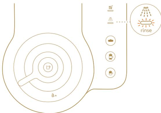
10. 在 牛奶噴嘴下方放置一個容器（至少 200 毫升）。把轉鈕轉到沖洗
