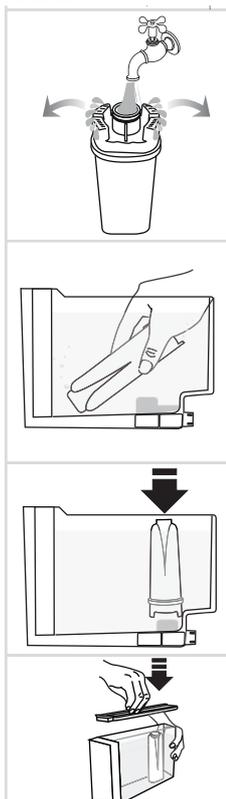
3. Pour activer le filtre, versez d'eau courant dans le trou du filtre, comme indiqué en figure, jusqu'à l'eau sorte des ouvertures latérales pour plus d'une minute.
