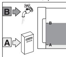
Verser le détartrant dans le réservoir à eau jusqu'au niveau **A** correspondant à une bouteille de 100ml estampé sur le côté du réservoir; puis ajouter de l'eau (un litre) jusqu'à atteindre le niveau **B**;
