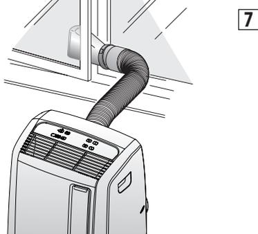
**Limite ao mínimo possível o comprimento e as curvas do tubo de ar evitando torcê-lo.**
