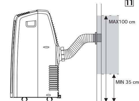
**NOTA:** caso efetue a instalação de tipo semi-permanente, deixe uma porta ligeiramente aberta (ainda que apenas 1 cm) para garantir uma ventilação correcta.
