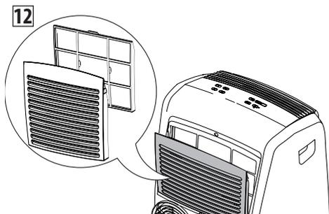
Para remover o pó depositado no filtro use um aspirador de pó. Se estiver demasiado sujo mergulhe-o em água morna enxaguando-o várias vezes. A temperatura da água deve ser mantida abaixo de 40° C.
