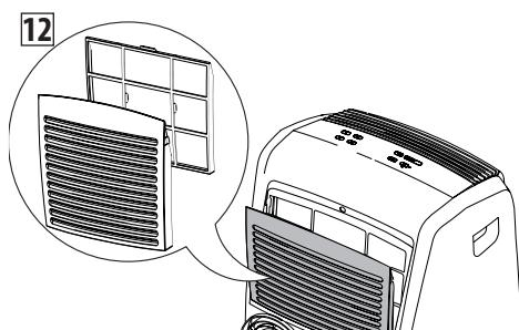
Για να αφαιρέσετε τη σκόνη που έχει επικαθήσει στο φίλτρο, χρησιμοποιήστε σκούπα. Αν είναι πολύ βρώμικο, βυθίστε σε χλιαρό νερό και ξεπλύνετε αρκετές φορές. Η θερμοκρασία του αέρα θα πρέπει να τηρηθεί κάτω από τους 40°C.
