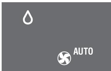
Es ideal para reducir la humedad de los ambientes (estaciones intermedias, locales húmedos, periodos de lluvia, etc.). Para este tipo de uso el aparato debe estar preparado en la misma forma prevista para el modo acondicionamiento, esto es, con el tubo de vaciado (B2) de aire aplicado al aparato para permitir la descarga de la humedad al exterior.
