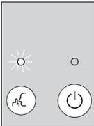
Wenn Sie diese Funktion im Klimatisierungsmodus einschalten, wird die Geräuschentwicklung des Geräts noch mehr reduziert. Zum Einschalten drücken Sie die Taste **STUMM** (C6), die Anzeige (C9) beginnt zu leuchten.
