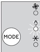
Diese Funktion ist ideal zur Reduzierung der Luftfeuchtigkeit im Raum (Frühjahr und Herbst, Feuchträume, Regenzeiten usw.). Für diese Art der Nutzung muss das Gerät wie im Klimatisierungsmodus eingerichtet werden. Das heißt, der Abluftschlauch (B1) muss am Gerät angebracht werden, damit die Feuchtigkeit nach außen abgeleitet werden kann.
